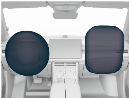
Рисунок: Срабатывание фронтальной подушки безопасности
