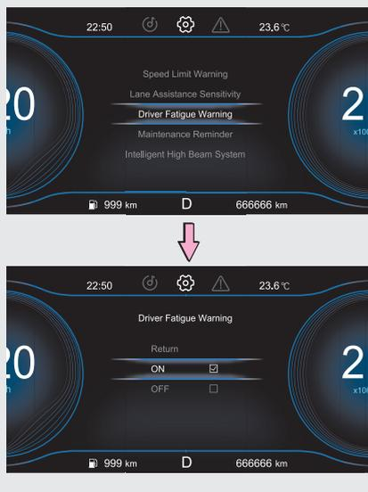
Индикатор усталости водителя можно включить или выключить с помощью кнопок на рулевом колесе.
