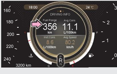
Отображается запас хода по топливу. Это максимальное расстояние (приблизительное), которое автомобиль может преодолеть на остающемся в баке топливе.
