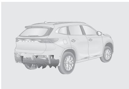
Если капли воды попали на поверхность ультразвуковых датчиков и замерзли, датчики не способны обнаружить препятствия.
