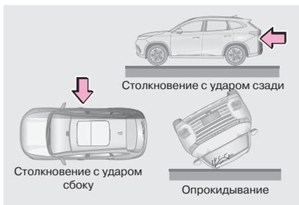
Как правило, подушки безопасности водителя и переднего пассажира не срабатывают при столкновении с ударом сзади или сбоку, при опрокидывании автомобиля и при фронтальном столкновении на малой скорости.
