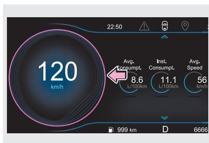
Цифровой спидометр служит для отображения скорости движения автомобиля (в км/ч).
