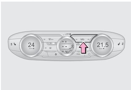
При нажатии выключателя системы AQS загорается расположенный в левой его части индикатор, указывая на то, что система контролирует качество воздуха в салоне автомобиля.
