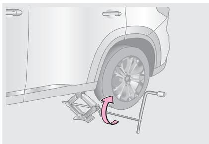
Для подъема автомобиля домкратом установите ручку домкрата на домкрат, вставьте колесный ключ в ручку домкрата, затем вращайте колесный ключ по часовой стрелке. Как только головка домкрата коснется опорной площадки на кузове и начнет поднимать автомобиль, еще раз проверьте правильность установки домкрата.
