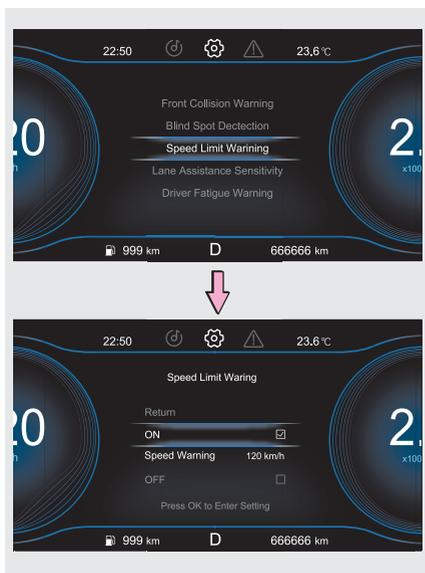
Функцию сигнализации о превышении установленного предела скорости можно включить или выключить с помощью кнопок на рулевом колесе.
