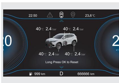
Когда выключатель пуска двигателя находится в положении ON, короткое нажатие кнопки
