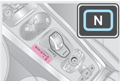
Доступны следующие положения рычага селектора: P, R, N и D в режиме автоматического переключения и M (+, -) в режиме ручного переключения. Текущее положение рычага селектора отображается на multifunctionальном дисплее приборной панели.
