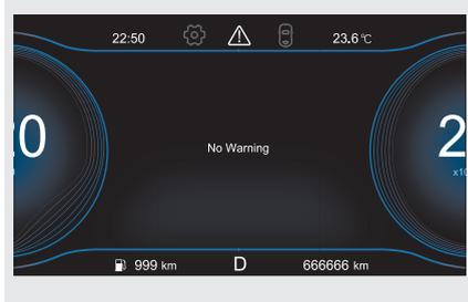
Если система бортовой диагностики автомобиля обнаружит неисправность и не подлежащую работу какой либо системы, то после установки выключателя пуска двигателя в положение ON на информационный дисплей будут поочередно выведены соответствующие предупреждения. Эти предупреждения сохраняются на экране списка предупреждений.
