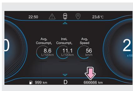
Отображает суммарный пробег автомобиля с начала его эксплуатации.
