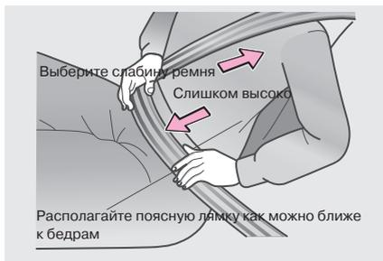
Ремень блокируется при резком вытягивании его из катушки, но не блокируется при плавном вытягивании. Расположите поясную лямку ремня как можно ближе к бедрам, но не на животе, затем отрегулируйте натяжение, потянув плечевую лямку ремня вверх.
