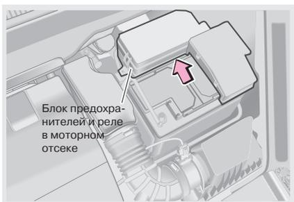
1. Выключите все потребители электроэнергии и установите выключатель пуска двигателя в положение OFF.
