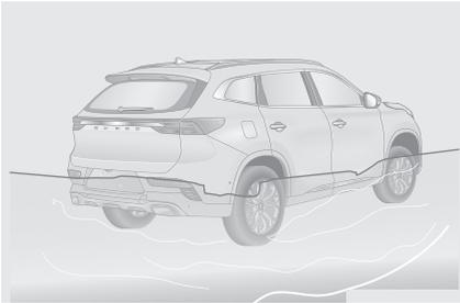
Автомобиль может получить серьезные повреждения, преодолевая водное препятствие, возникшее из-за сильного ливня и т.д. Если преодоление водного препятствия неизбежно, проверьте его глубину и двигайтесь медленно и осторожно.
