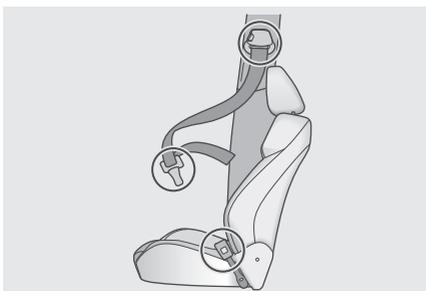
Периодически проверяйте состояние лент ремней безопасности (на предмет повреждения или износа). Растянувшиеся (например, в результате дорожно-транспортного происшествия) ремни безопасности и другие соответствующие детали подлежат проверке на сервисной станции официального дилера CHERYEXEED и, при необходимости, замене.
