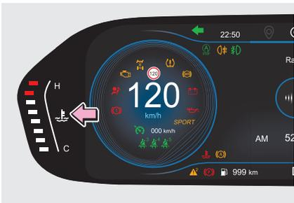
Когда выключатель пуска двигателя находится в положении ON, указатель отображает текущую температуру охлаждающей жидкости двигателя.
