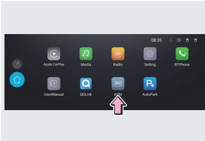
Монитор кругового обзора включен, когда выключатель пуска двигателя находится в положении ON, рычаг селектора находится в любом положении, кроме R (задний ход), и скорость автомобиля не превышает 30 км/ч. Монитор кругового обзора также включается при включении автоматической системы помощи при парковке. Необходимыми условиями для включения монитора кругового обзора является выключатель пуска двигателя, находящийся в положении ON, и скорость автомобиля, не превышающая 30 км/ч.
