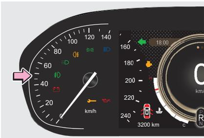
Спидометр служит для отображения скорости движения автомобиля (в км/ч) и представляет собой шкалу со стрелкой.
