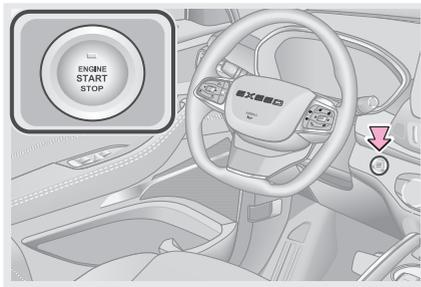
Держа пульт дистанционного управления при себе или положив его в автомобиле, переведите рычаг селектора в положение Р (стоянка) или N (нейтраль), нажмите педаль тормоза и нажмите выключатель пуска двигателя, чтобы запустить двигатель.
