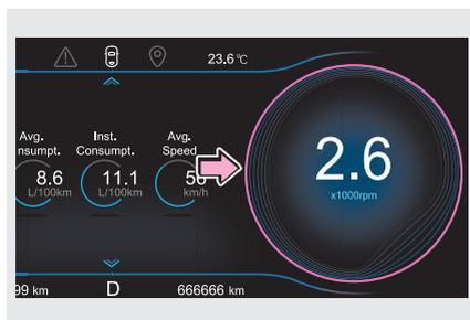
Цифровой тахометр служит для отображения текущей частоты вращения коленчатого вала двигателя (в об/мин).
