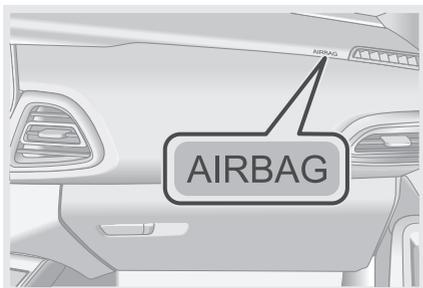
При срабатывании подушки безопасности переднего пассажира кожух подушки безопасности на панели управления открывается, и подушка наполняется газом.
