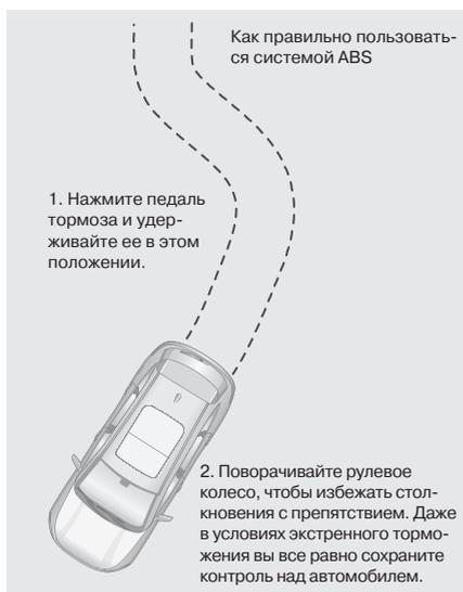
Антиблокировочная тормозная система (ABS) немедленно срабатывает при резком торможении; при этом сохраняются тормозные характеристики и управляемость автомобиля. При достаточном расстоянии до препятствия вы сможете объехать его.
