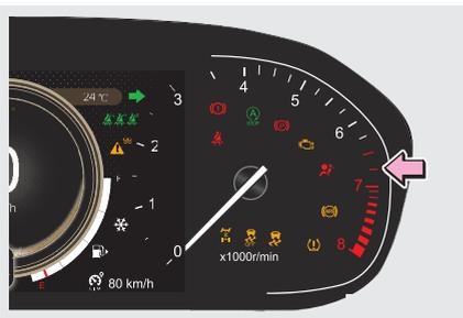
Тахометр служит для отображения текущей частоты вращения коленчатого вала двигателя (в об/мин) и представляет собой шкалу со стрелкой.
