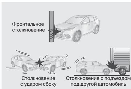
Подушки безопасности водителя и переднего пассажира могут не сработать при несильном столкновении автомобиля со столбом, при подъезде под грузовой автомобиль или другое препятствие либо при боковом столкновении под углом, как показано на рисунке.
