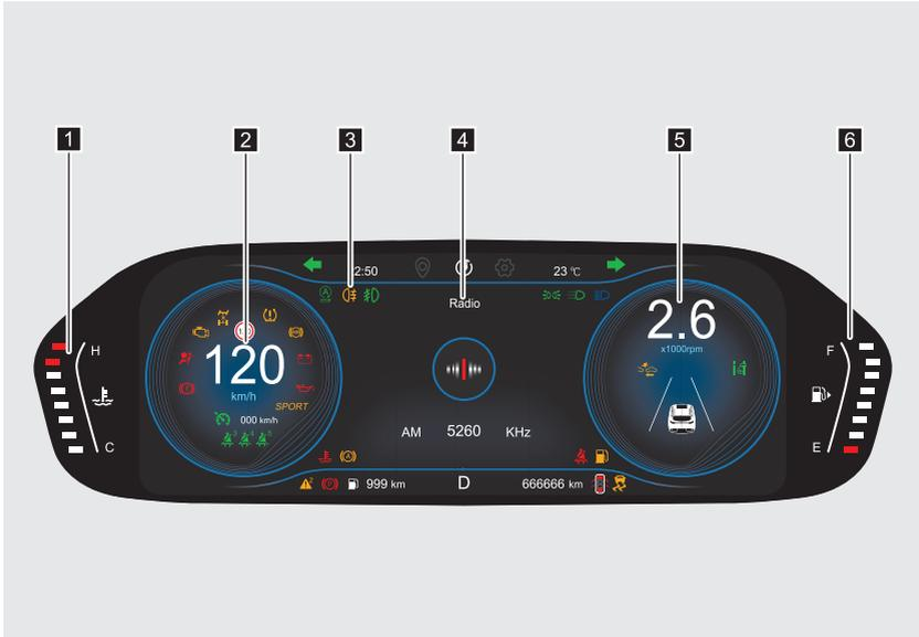
**1** Указатель температуры охлаждающей жидкости двигателя
