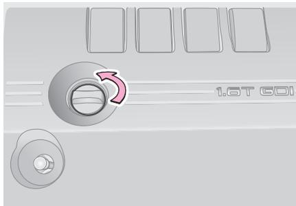
1. Отверните пробку маслозаливной горловины двигателя против часовой стрелки.
