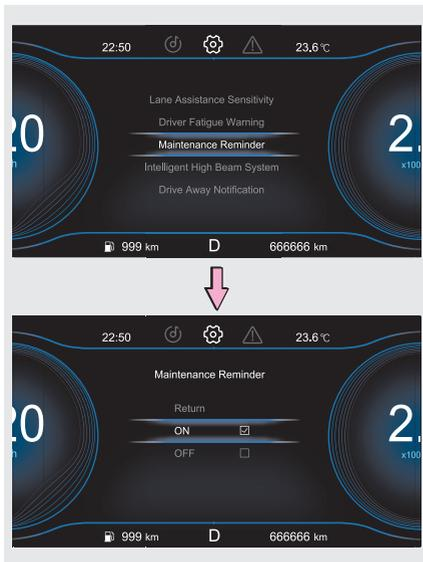
Напоминание о необходимости технического обслуживания можно включить или выключить с помощью кнопок на рулевом колесе.
