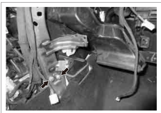
12. 拆下仪表板加强梁右侧 1 个螺栓和 1 个螺母
