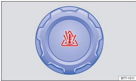
Рисунок 138. В моторном отсеке: крышка расширительного бачка охлаждающей жидкости двигателя (схематичное изображение)
