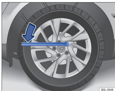
Рисунок 151. Замена колеса: откручивание колесных болтов
