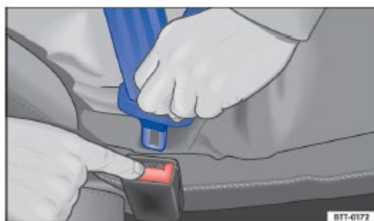
Рисунок 23. Высвободите язычок замка из замка ремня безопасности
