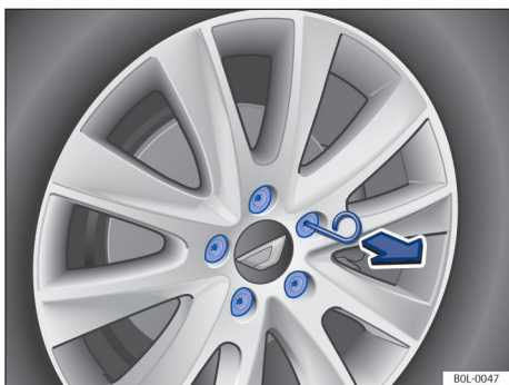
Рисунок 150. Снятие защитного колпачка с колесного болта (Схематическое изображение)
