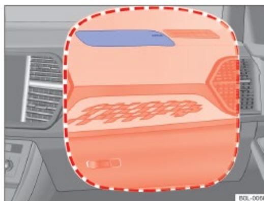
Рисунок 27. Положение установки и диапазон срабатывания фронтальной подушки безопасности переднего пассажира
