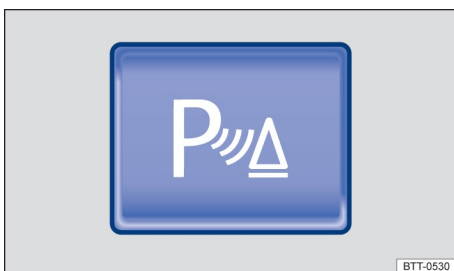
Рисунок 98. Верхняя часть центральной консоли: кнопка включения или выключения парковочного радара (Схематическое изображение)
