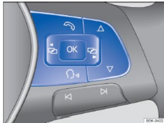
Рисунок 14. Правая сторона многофункционального рулевого колеса: клавиши управления меню приборной панели и информационного дисплея (данный рисунок приведен только в качестве примера)
