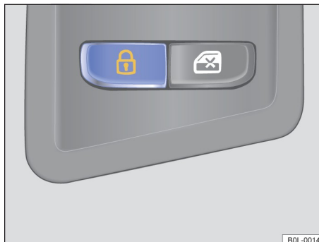
Рисунок 41. На двери водителя: кнопка управления центральным замком
