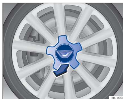
Рисунок 149. Снятие центральной накладки колеса
