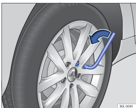
Рисунок 154. Замена колеса: снимите колесные болты с помощью торцевого ключа для колесных болтов
