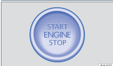
Рисунок 81. Нижняя часть центральной консоли: кнопка старт/стоп для запуска двигателя
