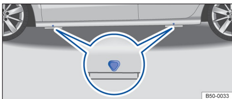
Рисунок 152. Точка опоры автомобильного домкрата
