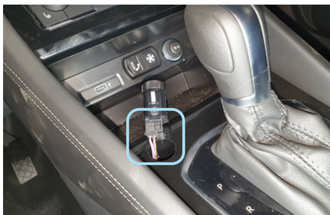
Фото 3.7. Местоположение разъёма кнопки Старт-Стоп
