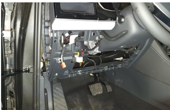
Фото 1.9. Пластиковая накладка под рулевой колонкой снята
