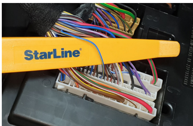
Фото 3.6. Управление центральным замком (сине-жёлтый)
