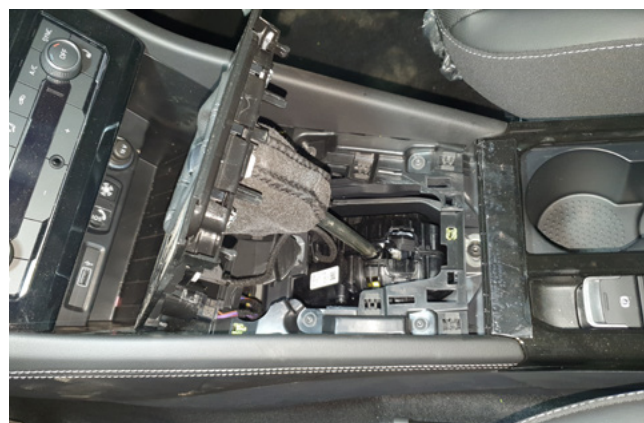
Фото 1.22. Накладка ручки селектора АКПП снята
