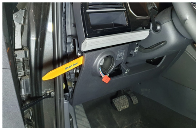
Фото 1.8. Снять пластиковую накладку под рулевой колонкой
