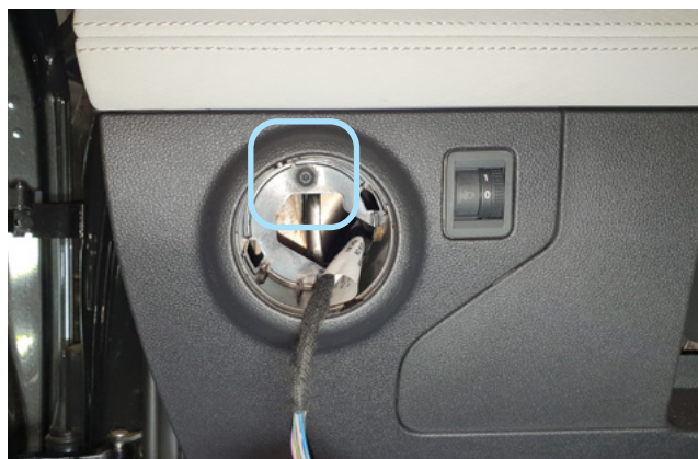
Фото 1.4. Переключатель света снят. Саморез
