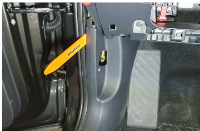
Фото 1.13. Снять накладку левой кик-панели
