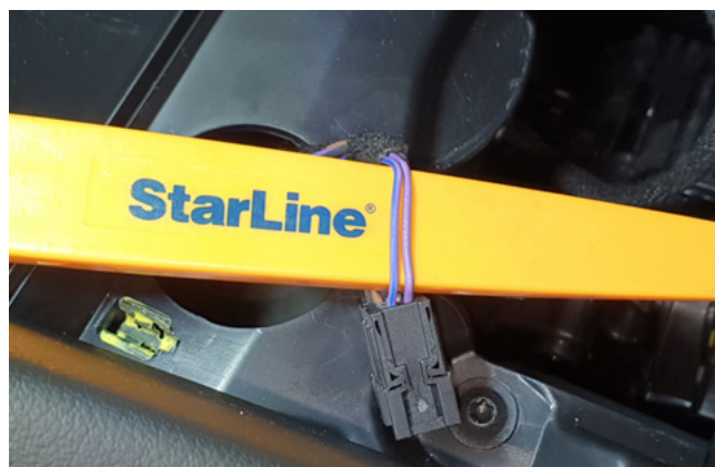
Фото 3.8. Управление кнопкой Старт-Стоп (фиолетовый и фиолетово-синий)
