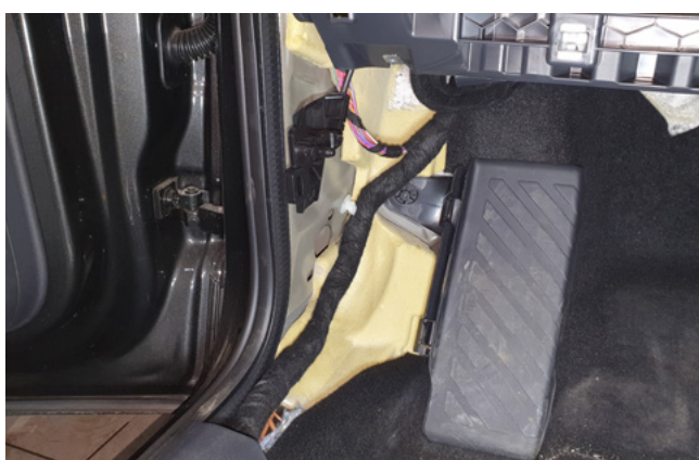
Фото 1.14. Накладка левой кик-панели снята
