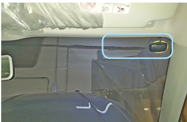
Фото 2.1. Возможное место установки антенного модуля
