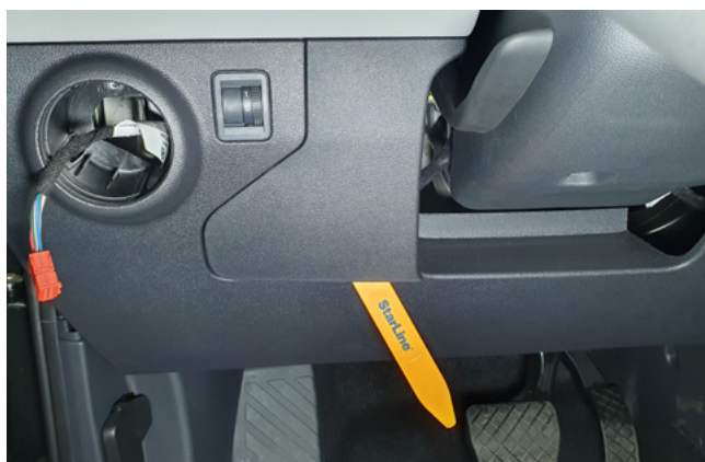
Фото 1.5. Снять крышку монтажного блока предохранителей
