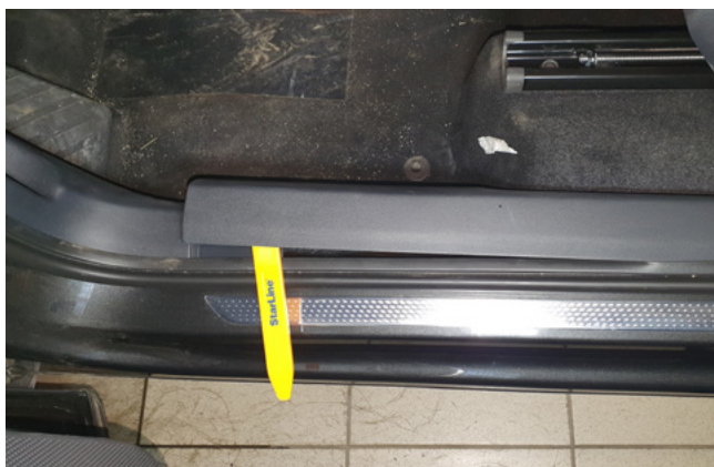
Фото 1.12. Снять накладку порога двери водителя
