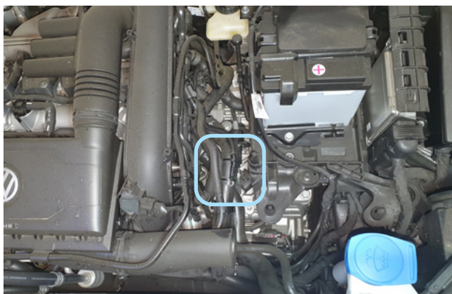
Фото 2.4. Место установки датчика температуры двигателя
