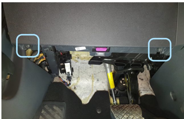
Фото 1.7. Саморезы крепления пластиковой накладки под рулевой колонкой
