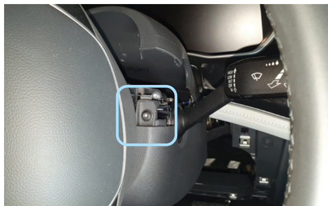
Фото 1.18. Винт крепления нижней части кожану руле- вого вала справа
