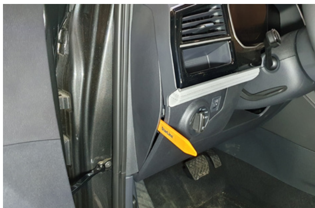
Фото 1.2. Снять боковую накладку передней панели
