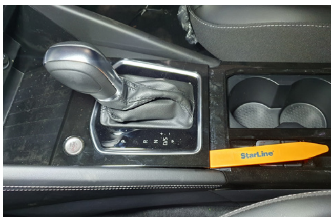
Фото 1.21. Снять накладку ручки селектора АКПП
