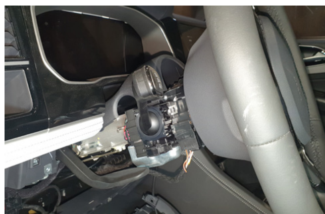
Фото 1.20. Кожух рулевого вала снят
