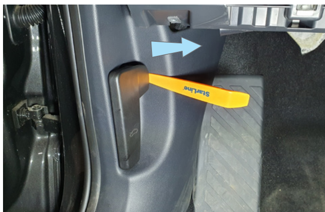
Фото 1.10. Сдвинуть фиксатор ручки отпирания капота в направлении стрелки
