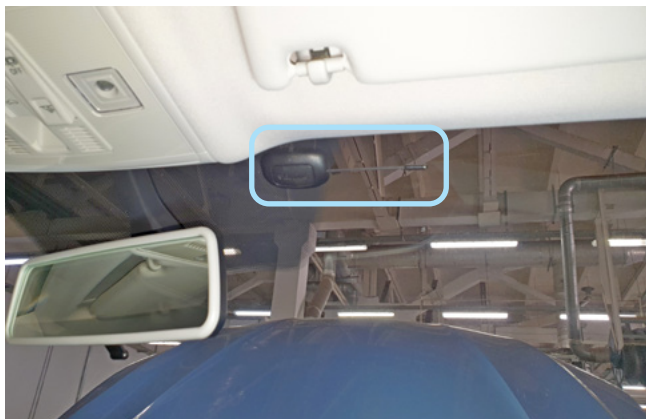
Фото 2.1. Возможное место установки антенны 868 МГц
