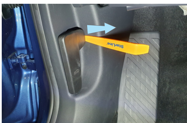
Фото 1.10. Сдвинуть фиксатор ручки отпирания капота в направлении стрелки
