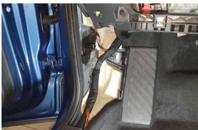
Фото 1.14. Накладка левой кик-панели снята
