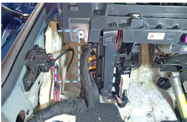
Фото 2.7. Пример расположения центрального блока охранно-телематического комплекса
