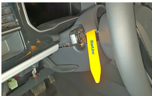
Фото 1.16. Снять верхнюю часть кожуха
