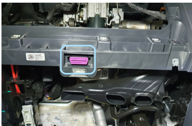
Фото 3.4. Местоположение диагностического разъёма
