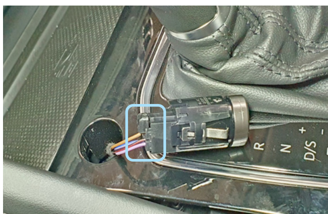
Фото 3.8. Местоположение разъёма кнопки Старт-Стоп
