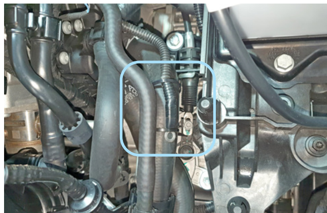
Фото 2.5. Крепление датчика температуры двигателя
