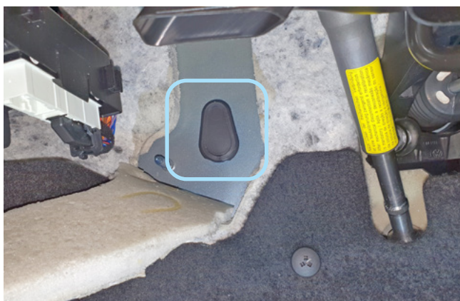
Фото 2.6. Штатный уплотнитель. Вид со стороны салона
