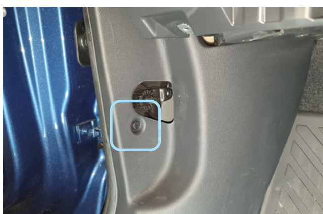
Фото 1.11. Ручка отпирания капота снята. Клипса крепления накладки левой кик-панели
