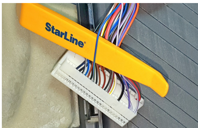
Фото 3.7. Управление центральным замком (сине-жёлтый)
