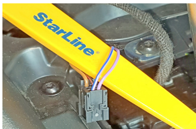
Фото 3.9. Управление кнопкой Старт-Стоп (фиолетовый и фиолетово-синий)
