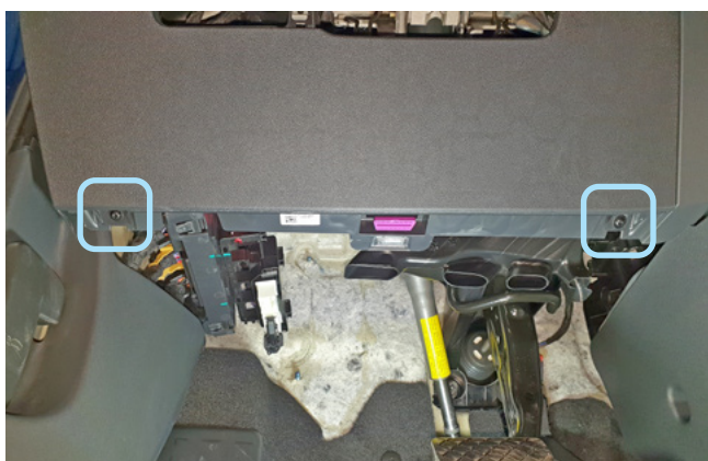
Фото 1.7. Саморезы крепления пластиковой накладки под рулевой колонкой
