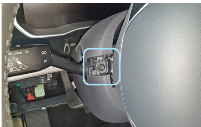
Фото 1.17. Винт крепления нижней части кожану рулевого вала слева
