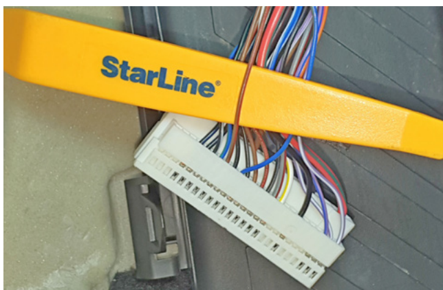
Фото 3.6. Управление световыми сигналами (коричнево-красный)
