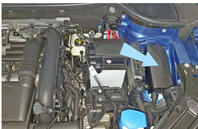
Фото 2.8. Возможное место установки подкапотного блока R6
