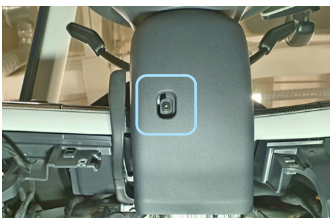
Фото 1.19. Винт крепления нижней части кожану рулевого вала снизу
