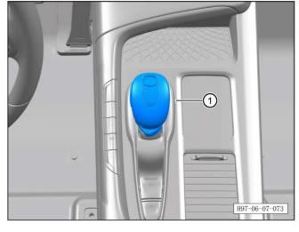
b. Disengage the shift lever  $\ensuremath{\mathbb{1}}$ .
