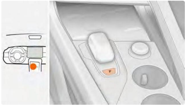
Шестерня Р: нажмите кнопку шестерни Р, чтобы включить передачу Р.
