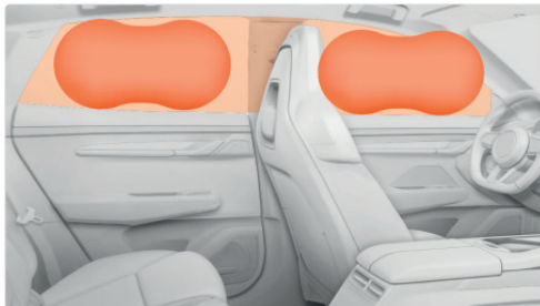
Раскрытие воздушных завес
