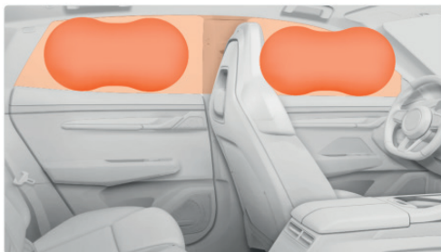
Раскрытие воздушных завес
